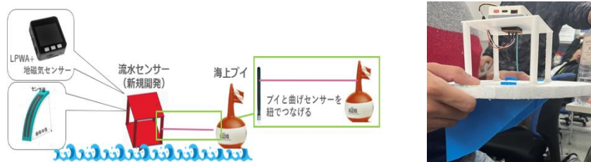
図 2 流水センサの機構と作成したプロトタイプ
