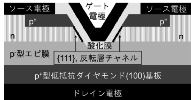
図 1. 目標とする縦型反転層チャンネルダイヤモンド MOSFET の構造
