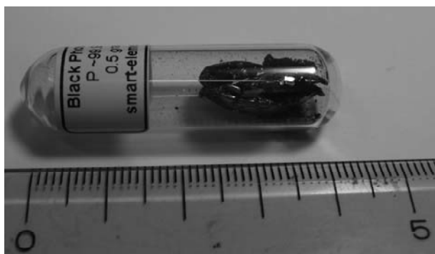
図3. 使用した黒リン(Smart elements製 純度99.998%)
