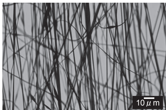
図2 エレクトロスピンニング法により紡糸したP3HTナノファイバの光学顕微鏡像
